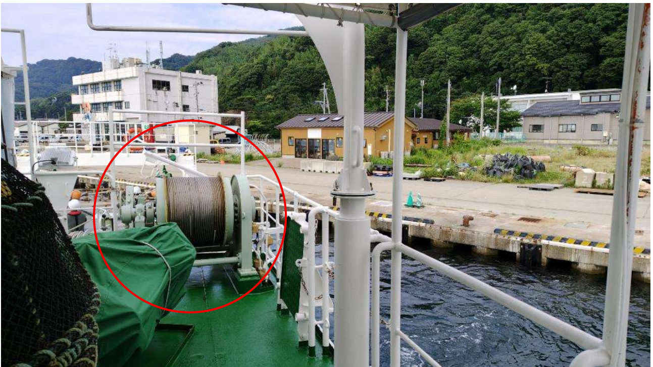
ドラム及び既存ワイヤーロープの設置状況 (設置状況を示す目的であり、新潟港での係船の状況を示すものではありません)
