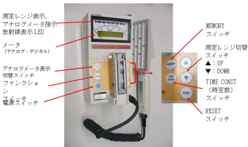
図 1-12 ZnS シンチレーション式サーベイメータ (TCS-362 型)
