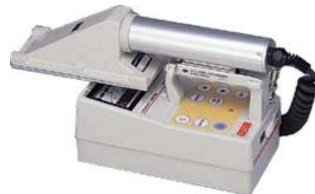
\alpha 線用放射性表面汚染サーベイメータ (ZnSシンチレーション式サーベイメータ)
