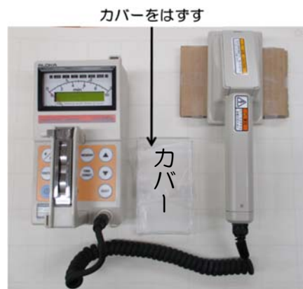
図1-13 \alpha 線に対する遮へい効果の測定方法
