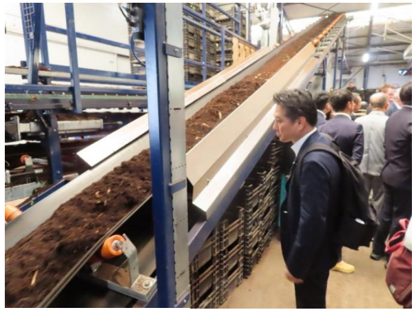
収穫した花の運搬は、ベルトコンベアにより自動化されている
