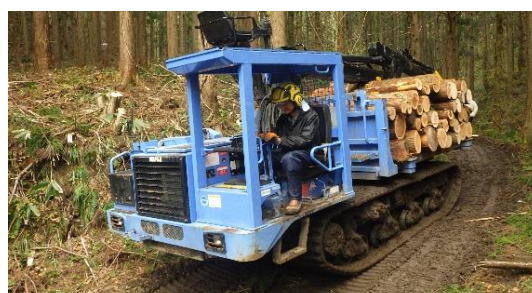
集材車両(フォワーダ)による木材搬出
