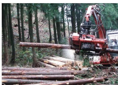
自走式造材機械(プロセッサ)による造材
