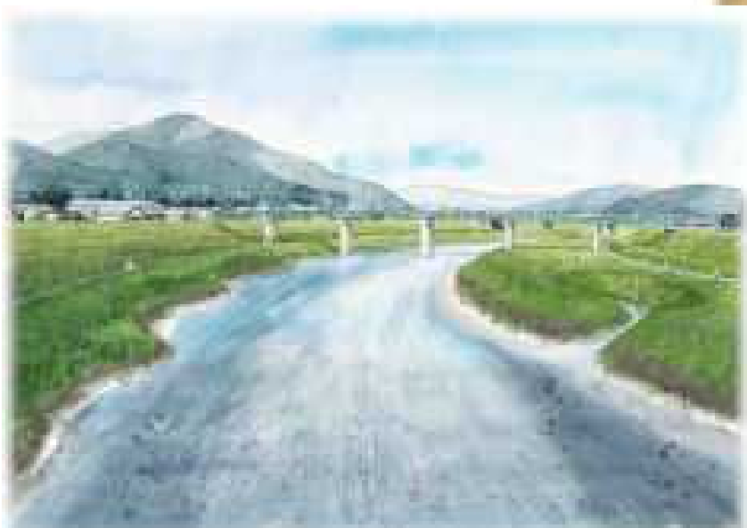
多様な水際が形成されるよう、低水水制やワンドを設置した川づくりの例
