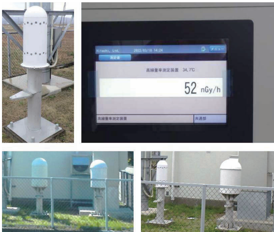
図1 外観図(左上:シリコン半導体検出器, 右上:シリコン半導体検出器の測定値表示部, 左下:更新前の検出器の設置外観, 右下:更新後の検出器の設置外観)
