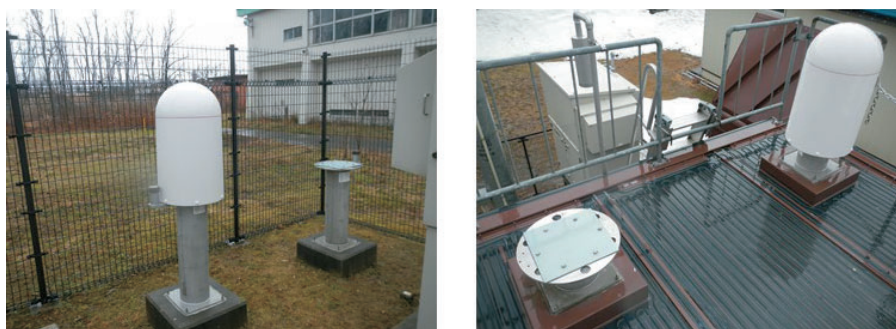
図1 外観図(左:地上設置型(寺泊局), 右:屋上設置型(加納局))
