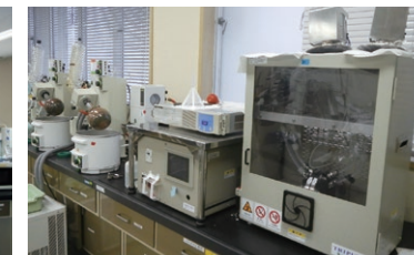
トリチウム濃縮装置
