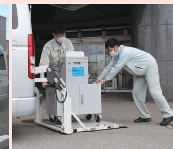
可搬型モニタリングポストの設置
