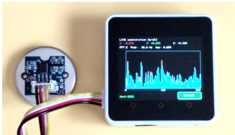
図1 測定器の外観（センサーは脱着を容易にするためマグネットに固定）
