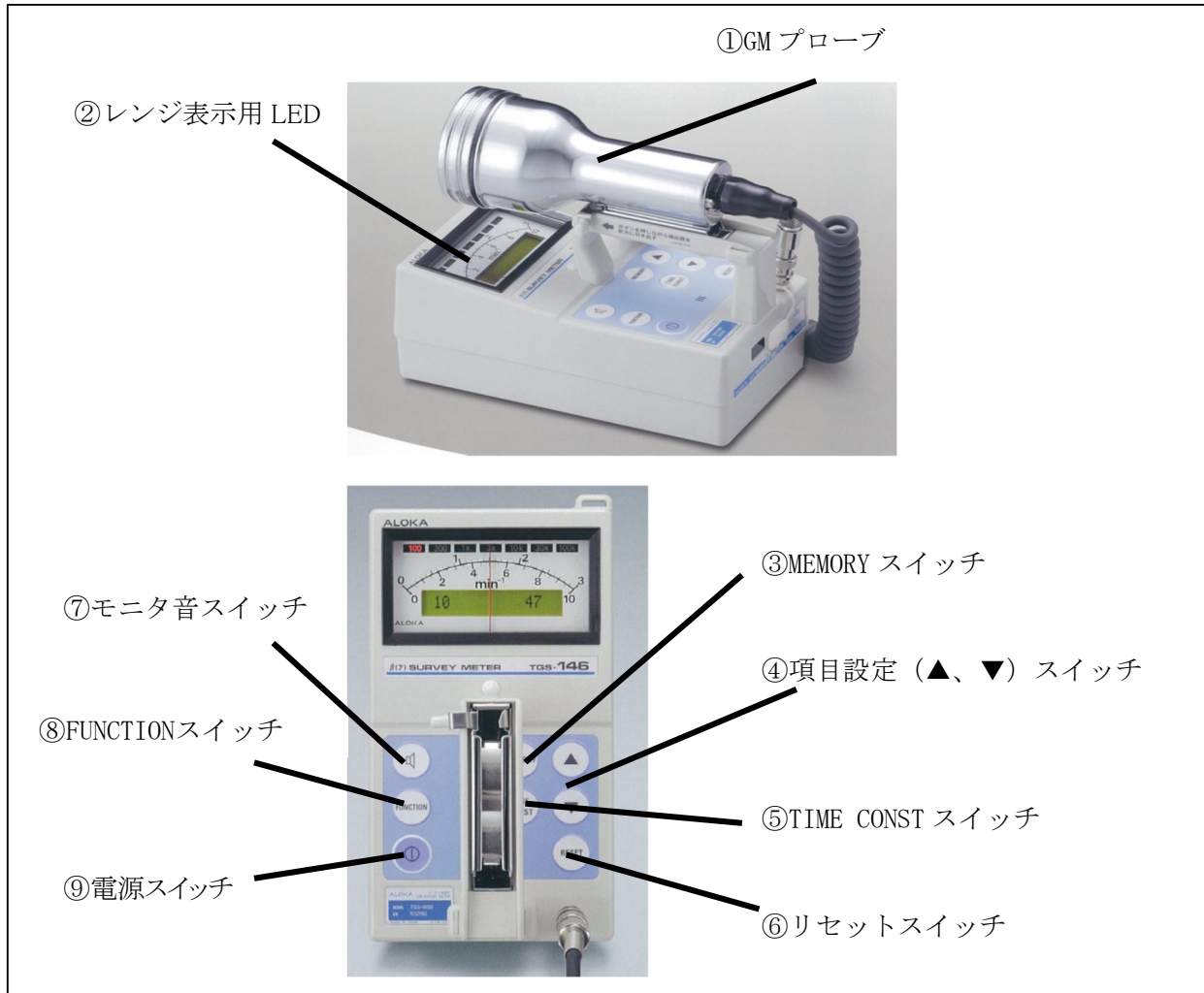
写真 GMサーベイメータ (アロカ製TGS-146B)
