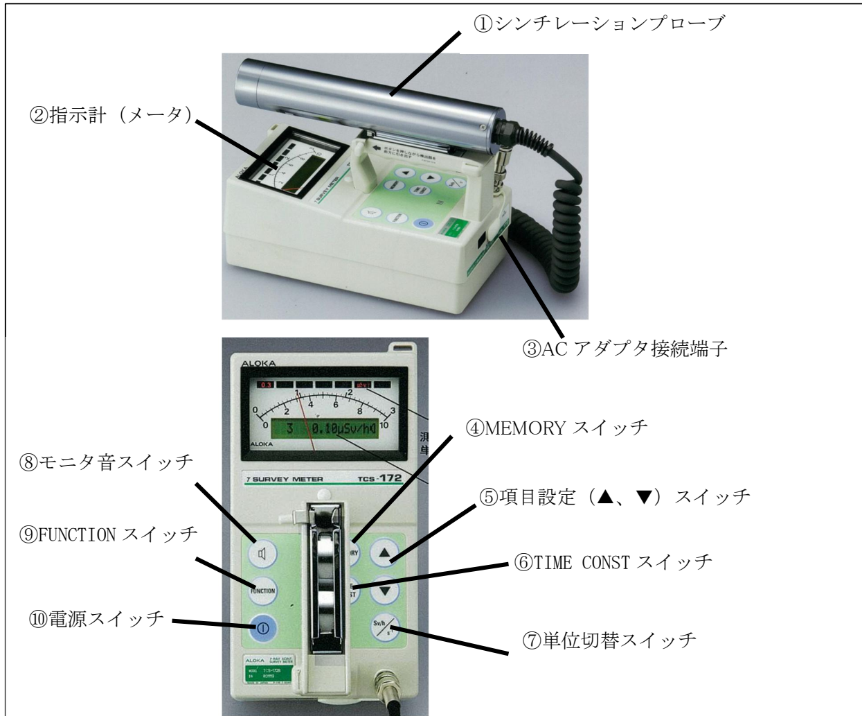
写真 NaIシンチレーション式サーベイメータ (アロカ製TCS-172B)
