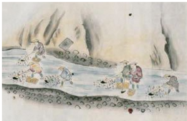
4) 水路底の土砂を「ねこだ」(ワラで編んだむしろ)に流しかけ、ねこだの編み目に砂金を付着させる。
