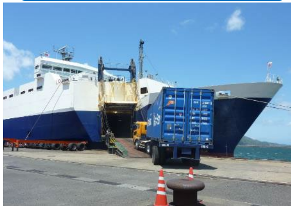
RORO船の荷役状況
