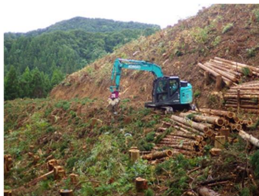
< 丸太を掴む機能のある機械による地拵え >
