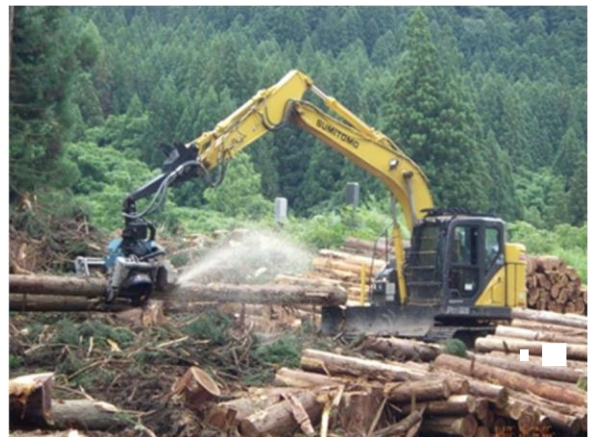
<高性能林業機械（プロセッサ）による素材生産>
