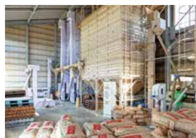
乾燥機 10tの生粉を収容する大型乾燥機2基を装備し、スマホで遠隔から確認できます。
