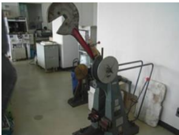
図 当センターにあるシャルピー衝撃試験機（最大容量 100J）
