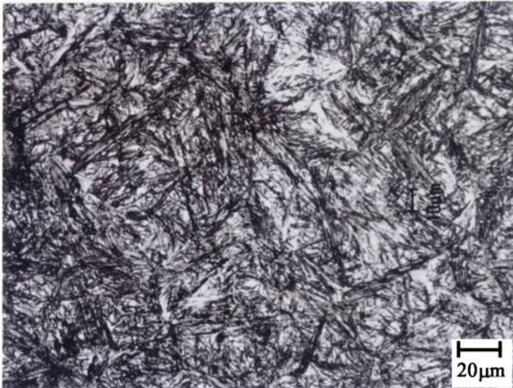
図9 焼入れ：900°Cに20分保持後、水冷 焼戻し：180°Cに1時間保持後、空冷
