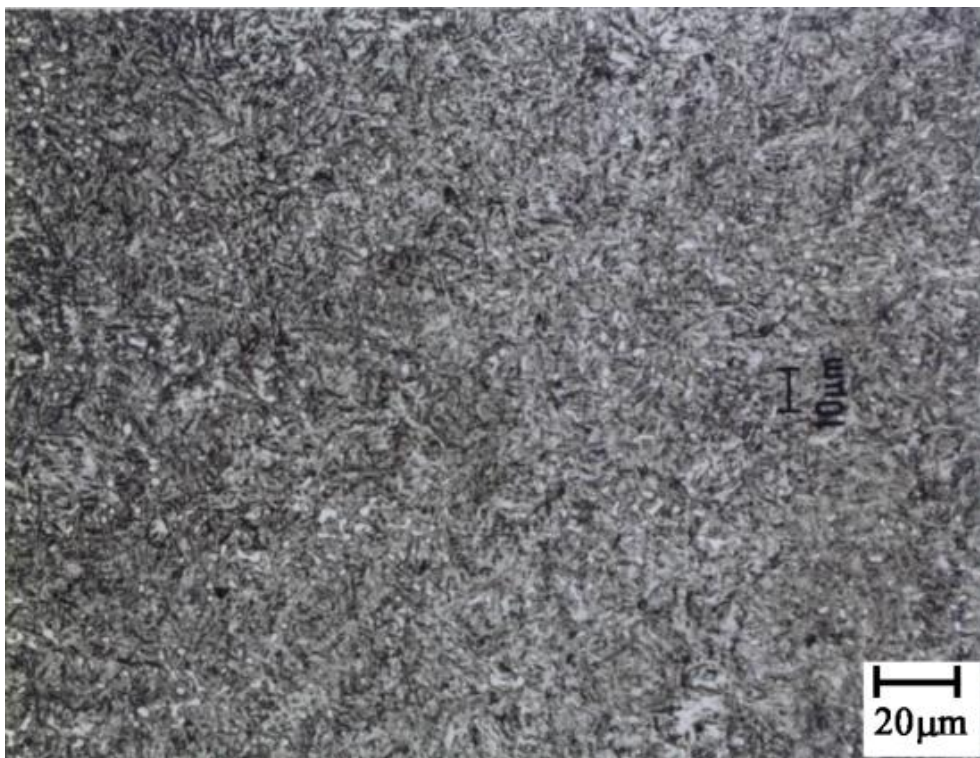
図4 焼入れ：775°Cに20分保持後、水冷 焼戻し：180°Cに1時間保持後、空冷
