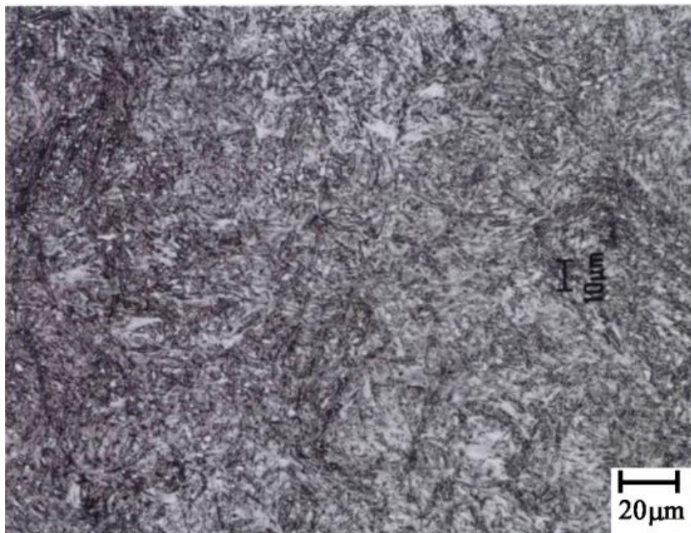
図6 焼入れ：825°Cに20分保持後、水冷 焼戻し：180°Cに1時間保持後、空冷
