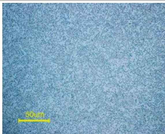
図1 供試材 (硬さ 167HV0.5、 フェライト、球状炭化物)
