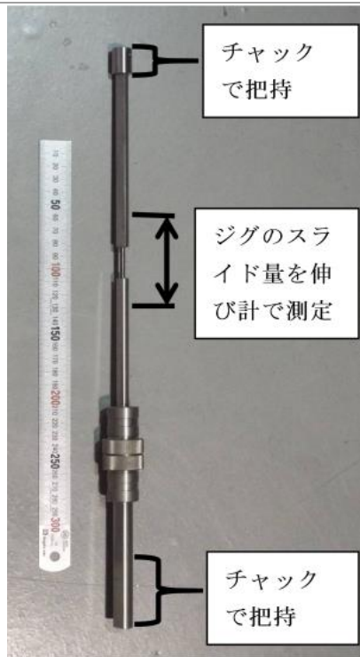
図2 伸び計の精度確認のためのジグ
