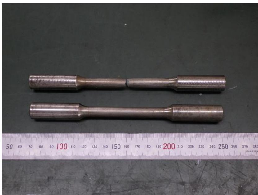
図3 引張試験の前後の試験片（上：試験後、下：試験前）
