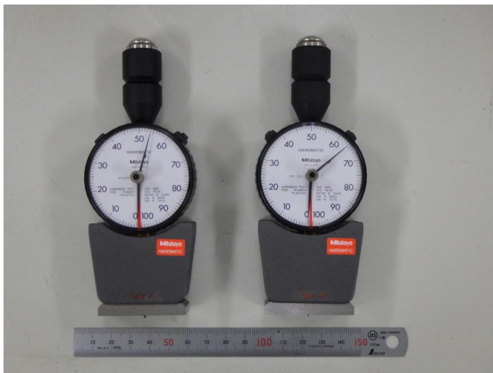
図2 デュロメータの外観（左：タイプ A、右：タイプ D）
