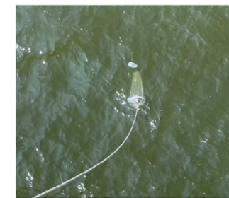
図 ネットによるマイクロプラスチック採取の様子
