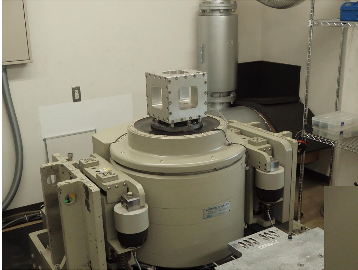
中越技術支援センター 振動試験機 立方体加振治具（200mm 角）試験時の風景
