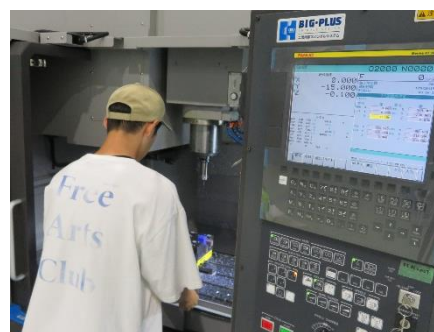
【マシニングセンタによる加工の様子】
