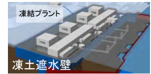
(延長: 約1,500m、凍土量: 約7万m 3 )
