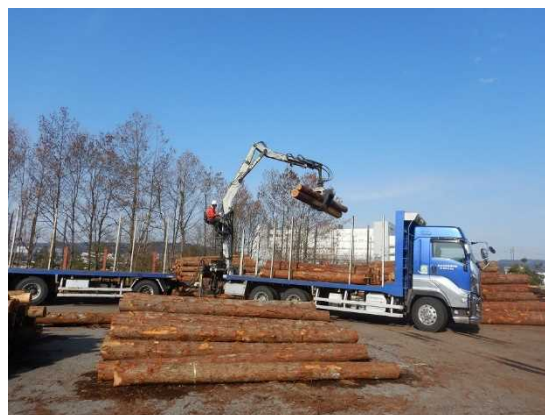
中間土場を活用した大型トラック運搬
