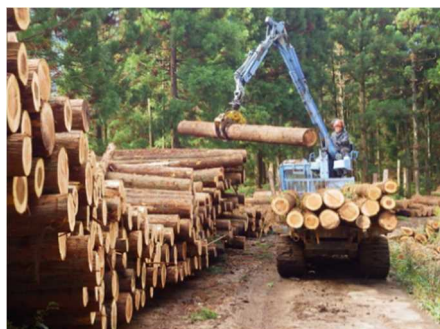
高性能林業機械（フォワーダ）による木材の搬出
