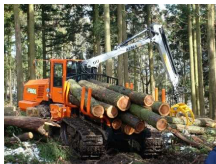
高性能林業機械（フォワーダ）による、間伐した木材の搬出
