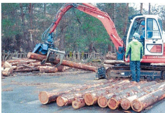
伐倒された丸太を造材するプロセッサの操作研修
