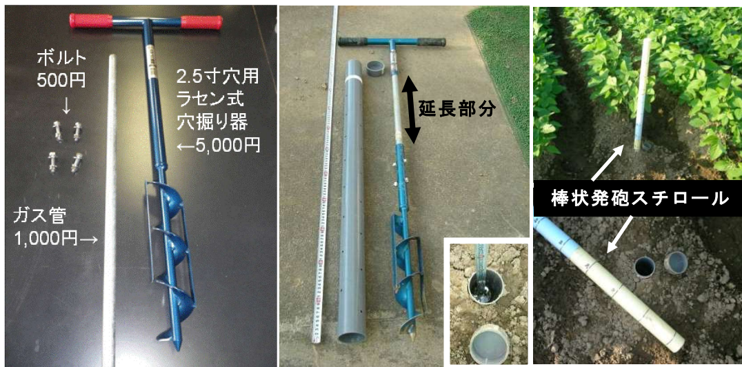
図1 ラセン式穴掘り器の柄の延長と発泡スチロールによる水位測定(価格は参考)
