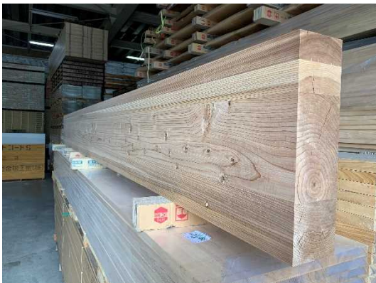
糸魚川産スギを利用し、重ねて接着させた大断面の建築材の製作及び強度試験（市内製材工場）
