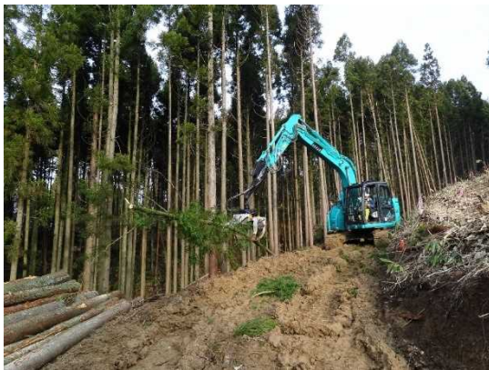
伐倒された丸太を造材するプロセッサの操作
