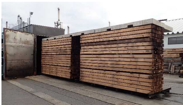
心去り材の曲がりを矯正する人工乾燥状況
