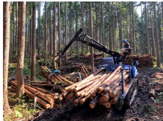
造材された木材を運搬するフォワーダの操作
