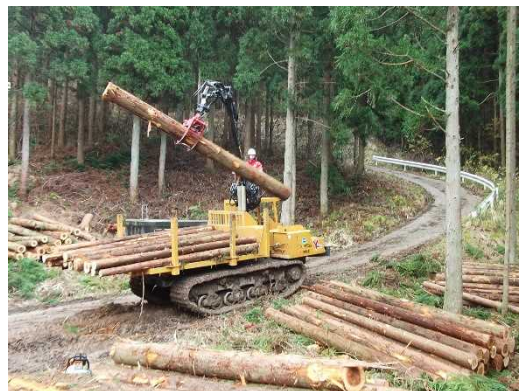
林業高性能機械（フォワーダ）による、間伐した木材の搬出
