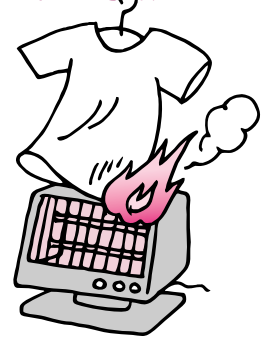
上部に干した洗濯物の落下による引火
