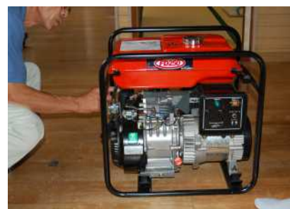
停電しても放送できるように 自家発電機もあります
