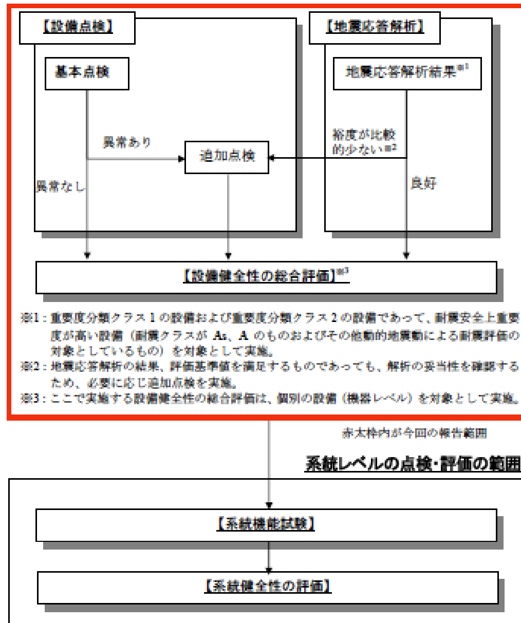
図-3.1.1 点検・評価の全体フロー
