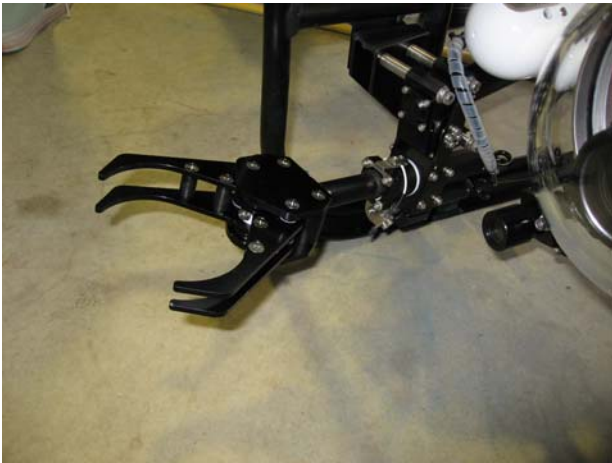
図3 小型マニピュレータ
