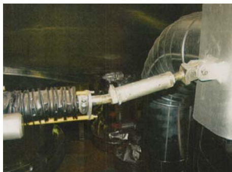
軸圧縮方向に過大な荷重が作用し座屈したオイルスナバ
