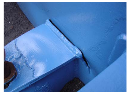
基礎ボルト，ブラケット破損
